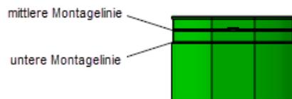
Platzieren Sie die Montagebox mit Hilfe einer Wasserwaage. Die abschließende Oberfläche muss zwischen unterer und oberer Montagelinie liegen. Die Box mit den Schrauben am Untergrund befestigen.
