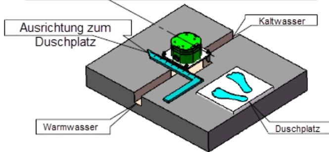
② Warm- u. Kaltwasserzuleitung an die Montagebox anschließen und abdichten
